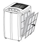
3 取出前置過濾網及 Molecular濾網 (新機濾網需取下塑料袋)
