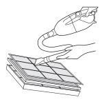
6 以吸塵器清潔或更換新過濾網 (前置濾網可水洗需晾乾後使用)
