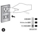
插回插頭,按(①)按鍵開啟清淨機.然後按住清潔或更換指示燈約5秒鐘,指示燈不再閃爍直至熄滅,計時器重新計時。此時已重新設定計時,等下次時間到再次提醒。
