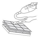
6 以吸塵器清潔或更換新濾網 (前置濾網可水洗需晾乾後使用)
